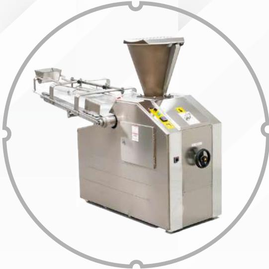
Una máquina de alta precisión y producción. Esta máquina divisora de masa está diseñada para dividir volumétricamente y prebolear masas. El funcionamiento de la divisora consiste en un pistón que absorbe la masa, la comprime y la expulsa. Este sistema proporciona una excelente precisión de peso sin castigar la masa.
