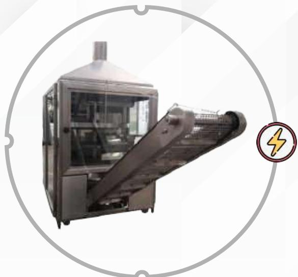
La máquina para hacer tortillas de harina está diseñada para producir tortillas de manera eficiente y uniforme. Su gran capacidad de 60 litros permite una producción continua, ideal para satisfacer las demandas de establecimientos de alta producción. La robusta estructura y el diseño ergonómico aseguran un rendimiento duradero y un uso cómodo.
